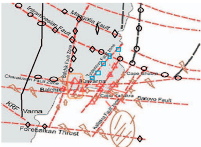
Фиг. 4. Схема на разломите, разломните системи, разломни сателити (кленове) и ешелони с елементи от тяхната геодинамична дейност (от Варна до крайбрежието на Южна Румъния)
